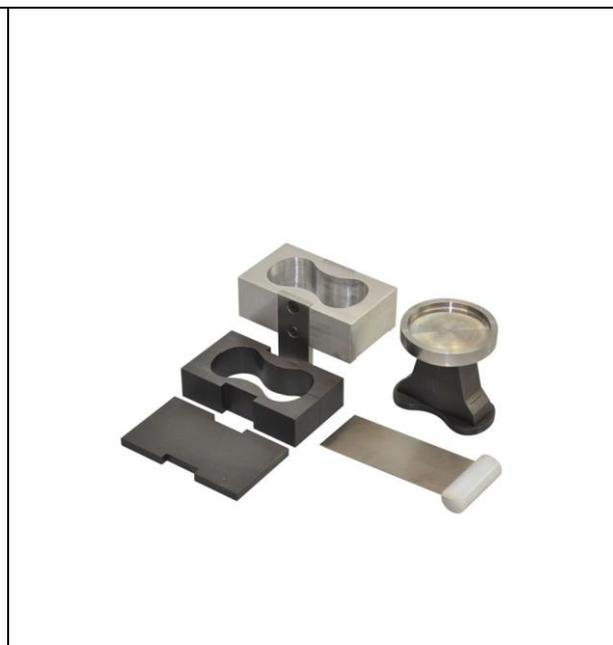
Figura 3 – Caixa de macho de flexão
