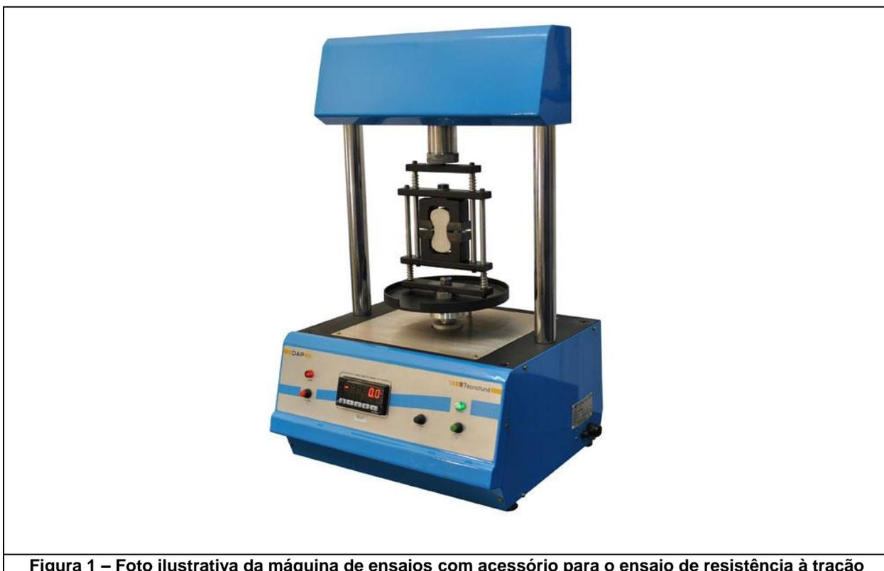
Figura 1 – Foto ilustrativa da máquina de ensaios com acessório para o ensaio de resistência à tração
